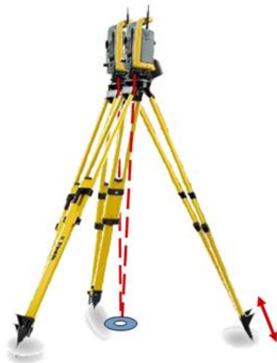
Рисунок 1: Технология Trimble SurePoint устраняет ошибки горизонтирования в электронных тахеометрах Trimble серии S
