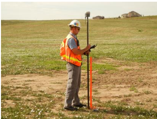
Рисунок 2: Ошибка центрирования увеличивается при наклоне вехи
